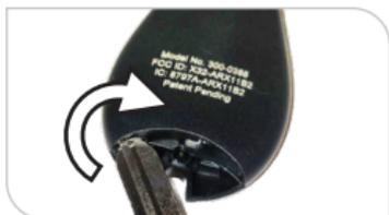
1. Deslice el pestillo mecánico de la parte delantera del lateral del llavero y retire la llave de emergencia al tirarla hacia abajo de la parte inferior del llavero.
